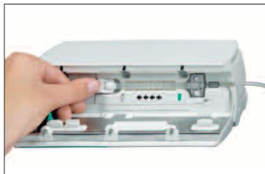
No passo seguinte, coloque o clip branco evitando a rotação da Linha sobre si própria.
