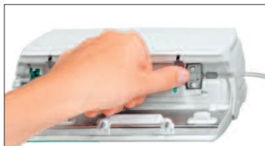
Insira a linha de infusão da direita para a esquerda. Assegure-se que a linha é colocada corretamente. Oriente a linha pelo sensor de upstream. Em seguida, insira o clip de encaixe de dois furos.
